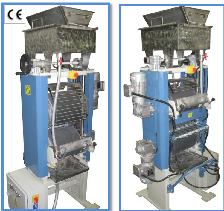
Zdjęcia poglądowe walcowej nakładarki kleju DOVK
